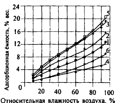
Рис. 1. Изменение степени набухания различных волокон от относительной влажности окружающего воздуха 1-хлопок; 2- шерсть; 3- шелк натуральный; 4- нейлон 66; 5- вискоза; 6- ацетат целлюлозы.
